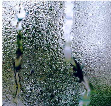
Abb. 4: An Fenstern und Spiegeln gut zu sehen: Kondensatbildung an kalten Flächen. Das Gleiche passiert an kalten Wandflächen - meistens unsichtbar!
